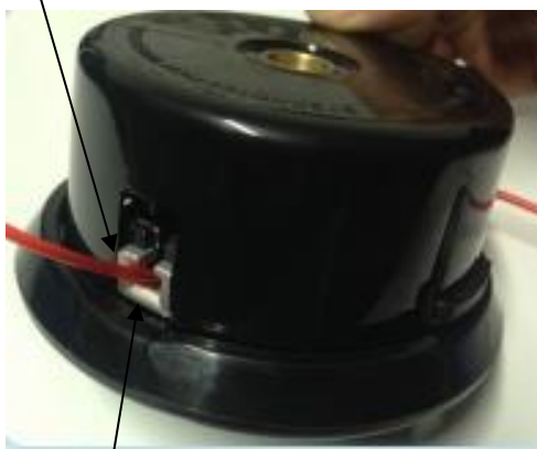
Gniazdo żyłki nylonowej w osłonie głowicy
